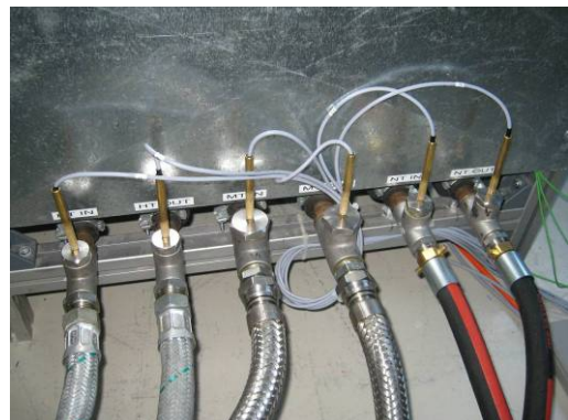
FIGURE 7 : RACCORDEMENT DES CIRCUITS A LA MACHINE SORTECH (DE GAUCHE A DROITE : HT; MT; LT) AVEC LES SONDES DE TEMPERATURE PERMETTANT DE FAIRE LES BILANS D'ENERGIE
