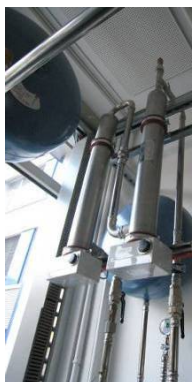
FIGURE 16 : CORPS DE CHAUFFE ELECTRIQUES EMULANT LES CAPTEURS SOLAIRES
