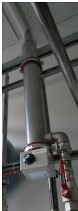
FIGURE 19 : CORPS DE CHAUFFE ELECTRIQUE EMULANT LE BATIMENT
