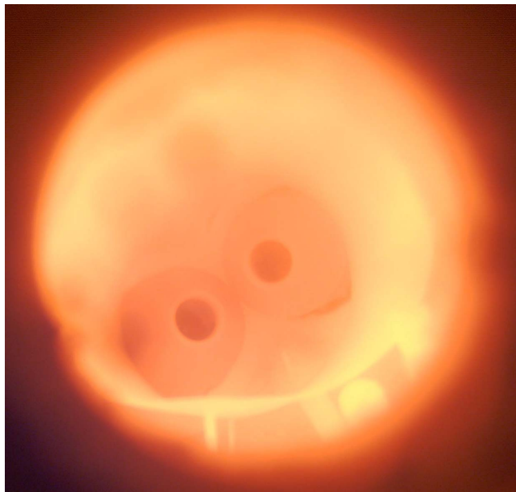
Abbildung 3 Blick in die Brennkammer bei Betriebstemperaturen um 1150°C. Im Vordergrund (hell) das Leitrohr und die keramisch gekapselten Temperaturfühler. In der Bildmitte die beiden Rekuperator-Austrittsdüsen. Die leichten Deformationen des Leitrohres haben keinen Einfluss auf die Messresultate, wodurch anstelle eines neuen Keramikblech-Bauteiles das Leitrohr aus warmfestem Stahl der Schwachgasfackel im Tessin nochmals verwendet werden konnte, welches dort vom November 2006 bis April 2008 im Einsatz war.
