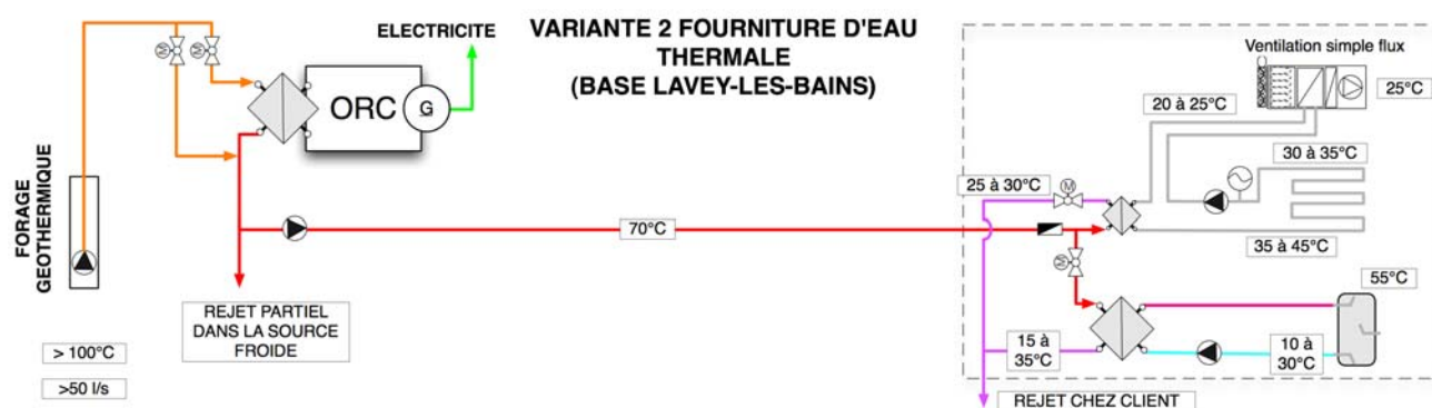
Figure 4.10 : Schéma qui illustre la variante "Chauffage par distribution d'eau thermale" (variante 2).
