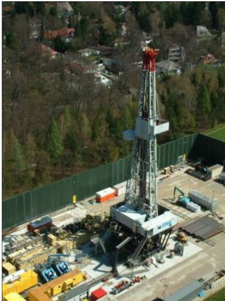
Tour de forage à Pullach près de Munich (D). Profondeur atteinte : 3'330 m; température de l'eau : 111°C
