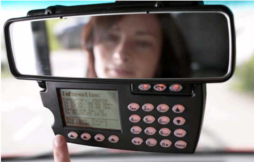
Figur 6: Bordcomputer der Mobility-Fahrzeuge auf der Basis des GSM Netzes für Handys.
