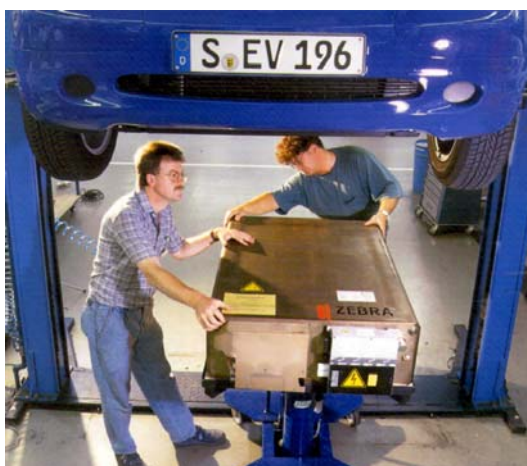
Figur 14: Einbringen der Zebra-Batterie in eine Mercedes A-Class „Elektro“, 30 kWh Energie, 370 kg
