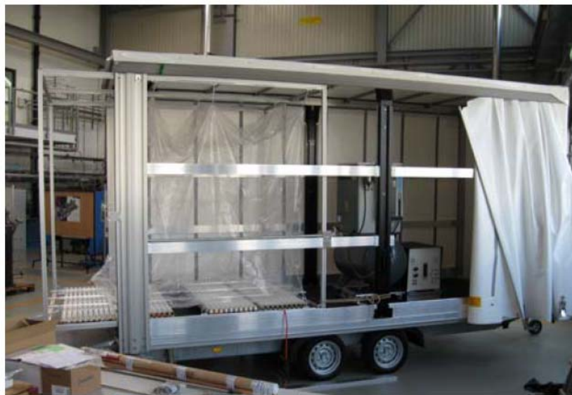
Figur 13: Mobile Messfahrzeug und mobile Smogkammer des Paul Scherrer Instituts
