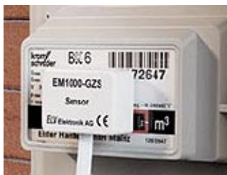
Fig. 5: Infrarot-Sensor zur Auslesung eines Gaszählers (Quelle: [7])
