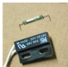
Fig.4: Bauteile eines Reedkontakts (Quelle: [35])
