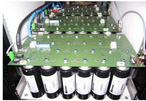
Abbildung 7: Teilmodule der Superkapazitäten eingebaut im Rack
