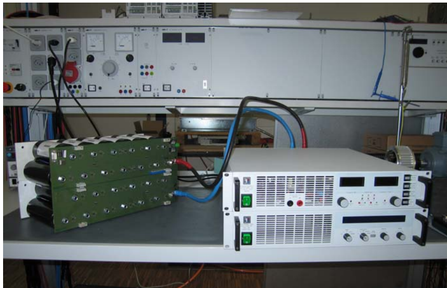
Abbildung 31: Scap-Modul mit Ladegerät
