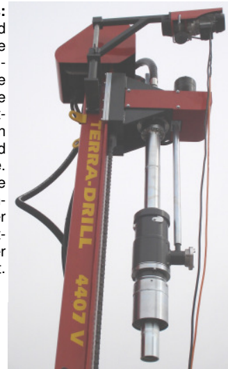
Bild rechts: Antriebskopf und Duplexaufnahme (Patent angemeldet). Die Duplexaufnahme erlaubt das zeitgleiche Abteufen der Futterrohre und der Bohrgestänge. Das geförderte Bohrgut wird kontrolliert und sauber in einen Bohrgut-container abgeführt.
