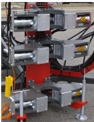
Bild links: Die 3-fach Klemm- und Brechvorrichtung.
