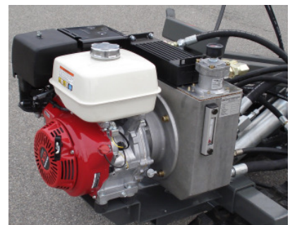
Bild rechts: Der Fahrtrieb treibt auch die Spülbohrpumpe an.
