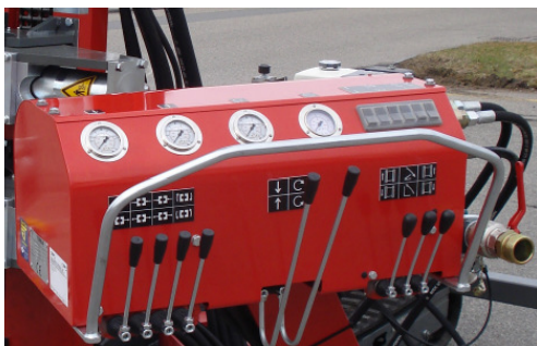
Bild links: Das übersichtliche Bedienpult wird seitlich in die gewünschte Arbeitsposition geschwenkt. Alle Funktionen werden hier gesteuert.
