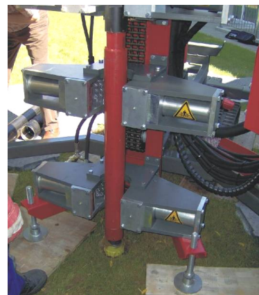
Bild rechts: Der Imlochhammer bohrt durch nahezu jedes Erdreich. Selbstverständlich bohrt er auch durch felsigen Untergrund. Er stellt einen Bohrkana von 150 mm her.
