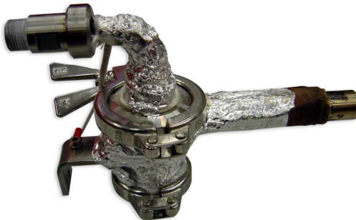
Abbildung 3. PM 10 -Zyklon zur Vorabscheidung von Partikeln >10 µm
