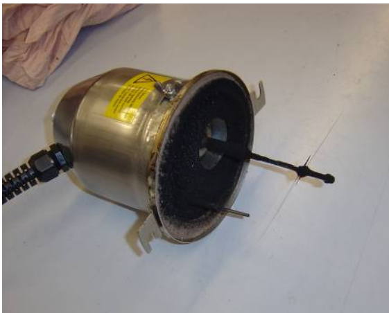
Abbildung A 2: Elektrostatischer Partikelabscheider Zumikron Kompaktversion, mit Sprühelektrode
