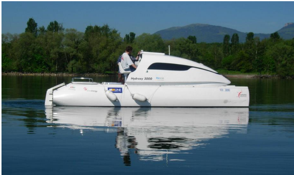
FIGURE 3.1 – Bateau Hydroxy 3000 fonctionnant sur pile à combustible.
