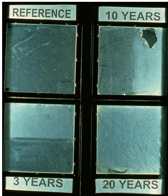
Fig. 42 Hagelschäden bei einer in Rapperswil exponierten FEP-Folie (FEP 1).
