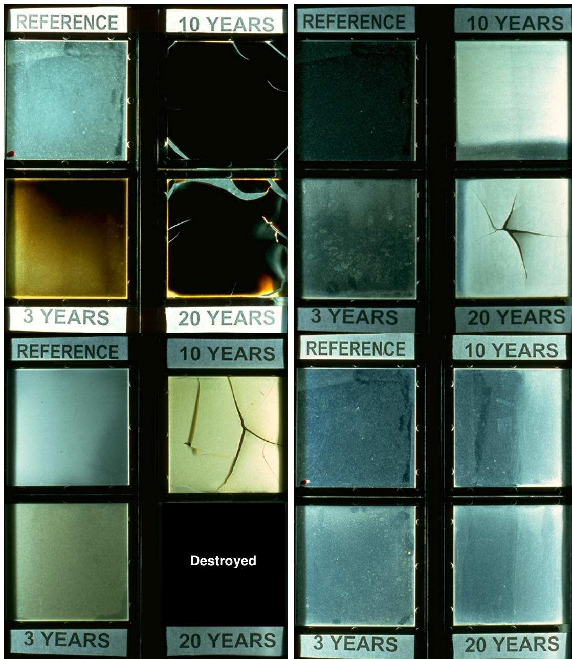
Fig. 48 Fotos von Expositionsreihen einiger Proben die unter einer Glasscheibe exponiert wurden. Oben links: PVC (PVC 2), oben rechts: PET (PET 2), unten links: PC(PCfo 1), unten rechts: FEP (FEP 2).
