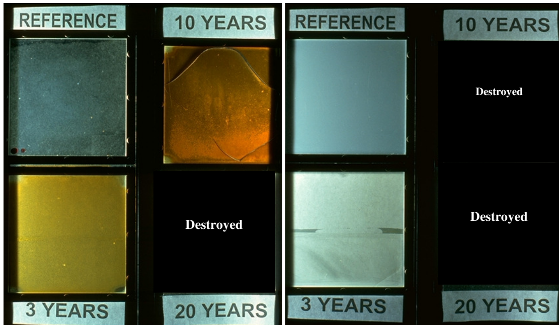
Fig. 46 Zerstörung von Kunststofffolien durch Wetterexponierung, Links: PVC, Rechts: PET
