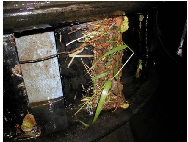
Fig. 9 Verschmutzung an den Stützschaufeln [9]
