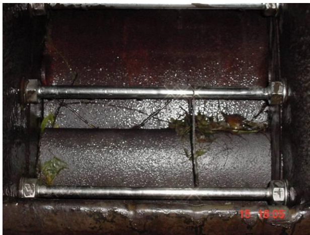
Fig. 10 Verschmutzung an den Leitschaufeln
