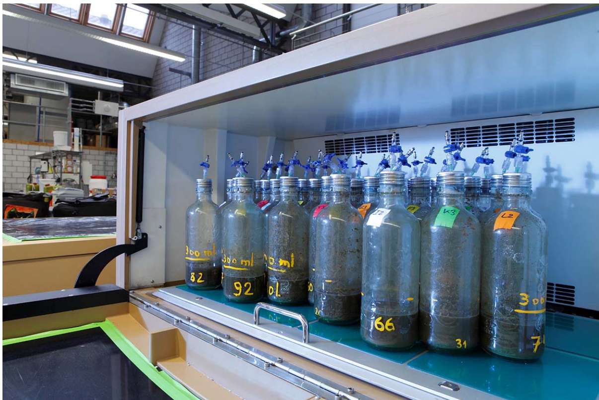
Abbildung 3: Inkubationsschüttler im geöffneten Zustand für die Gasbildungsversuche mit verschiedenen Güllefraktionen.
