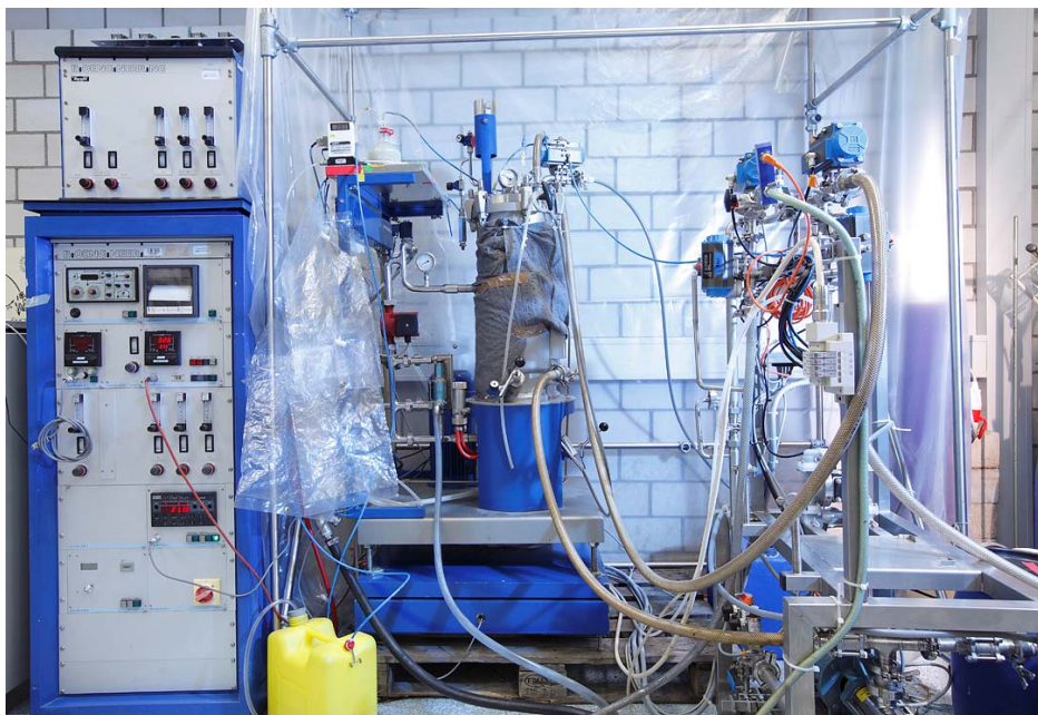
Abbildung 1: MBR-Laboranlage mit 20 L Nutzvolumen an der ZHAW in Wädenswil.
