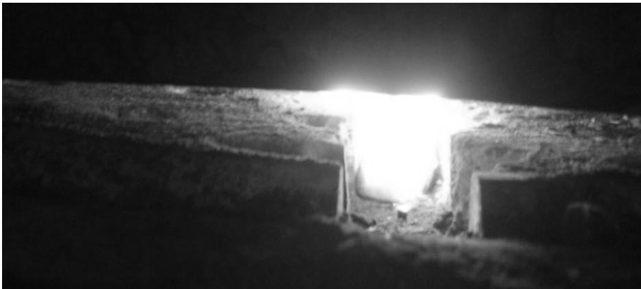
Abb 4 die Anfeuerwanne. Die Anfeuerhilfe brennt
