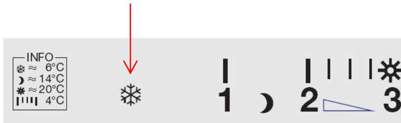
Abbildung 2.10: Einstellskala am Thermostatkopf
