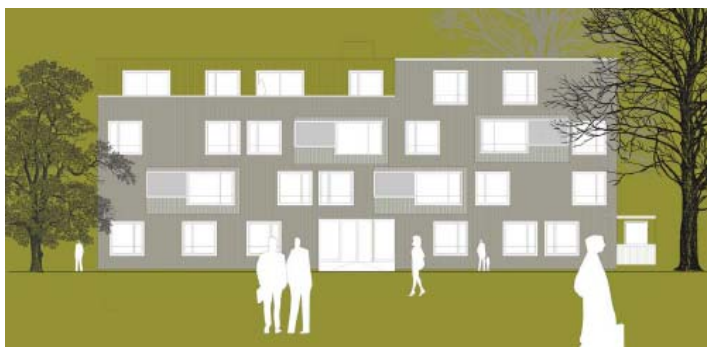
Fig. 1: Ansicht des Swisswoodhouse mit den angehängten Balkonmodulen
