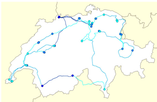
Abb.15: Relatives Erdbebenrisiko einzelner Komponenten - altes Netz (hellblau - gering, dunkelblau - hohe Häufigkeit, Linien - Kabel, Punkte – Server)
