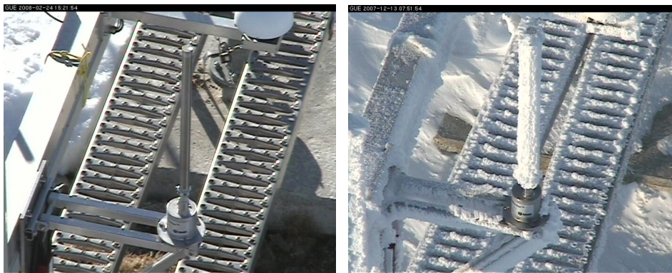
Abb. 6: Der Saab/Combitech IceMonitor Mk1 einmal ohne (links) und einmal mit (rechts) Eisansatz.
