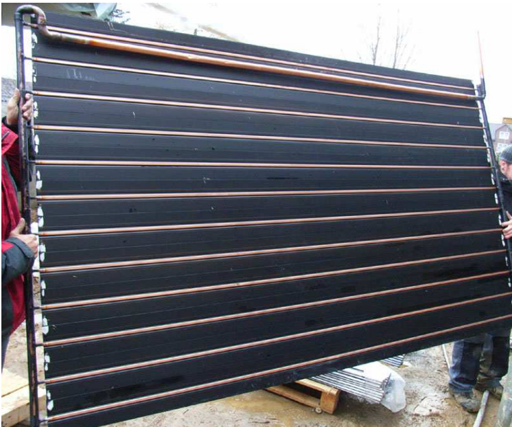
Abbildung 3-5: Absorberrückseite der Fassadenkollektoren
