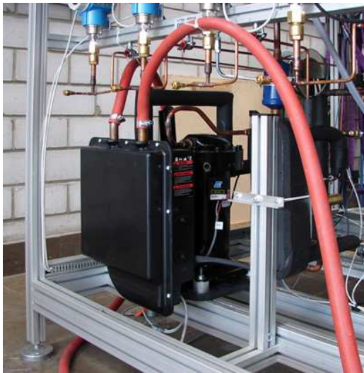
Figur 3: Inverter-Scroll Kompressor der 1. Generation mit aufgebautem Inverter im L/W-WP-Prototyp
