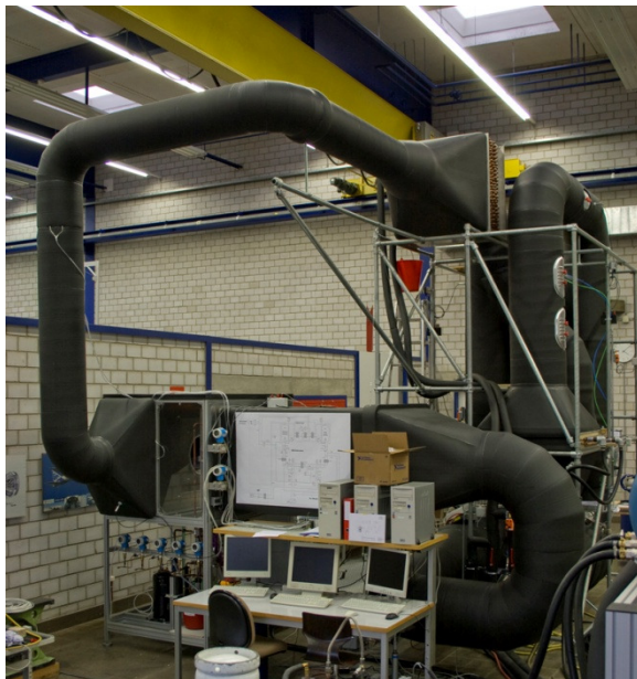
Figur 5: Prüfstand und Wärmepumpen-Prototyp im Labor der HSLU T&A
