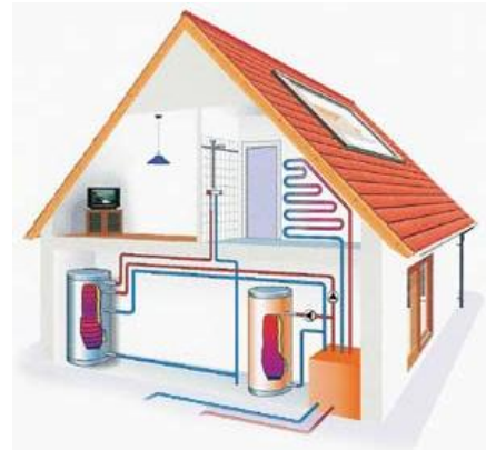
Abb. 14: Prinzip der Wärmepumpe
