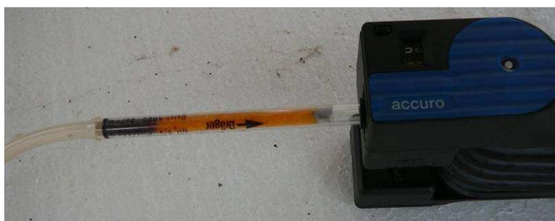
Figure 4-3 : Pompe et tube réactif pour le dosage de l'ammoniac
