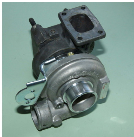
Abbildung 4 Aactor Mk II Funktionsmuster: Turbine vorerst mit hydrostatischer Lagerung. Der Zusammenbau von Verdichter und Turbine erfolgte aus zwei verschiedenen Fahrzeug-Turboladern. (Bild: Ökozentrum Langenbruck)
