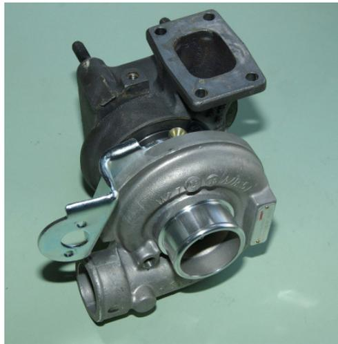
**Abbildung 2** Aactor Mk Funktionsmuster: Turbine mit hydrostatischer Lagerung. Der Zusammenbau von Verdichter und Turbine aus zwei verschiedenen Turboladern passt geometrisch ideal zusammen. (Bild: Ökozentrum Langenbruck)
