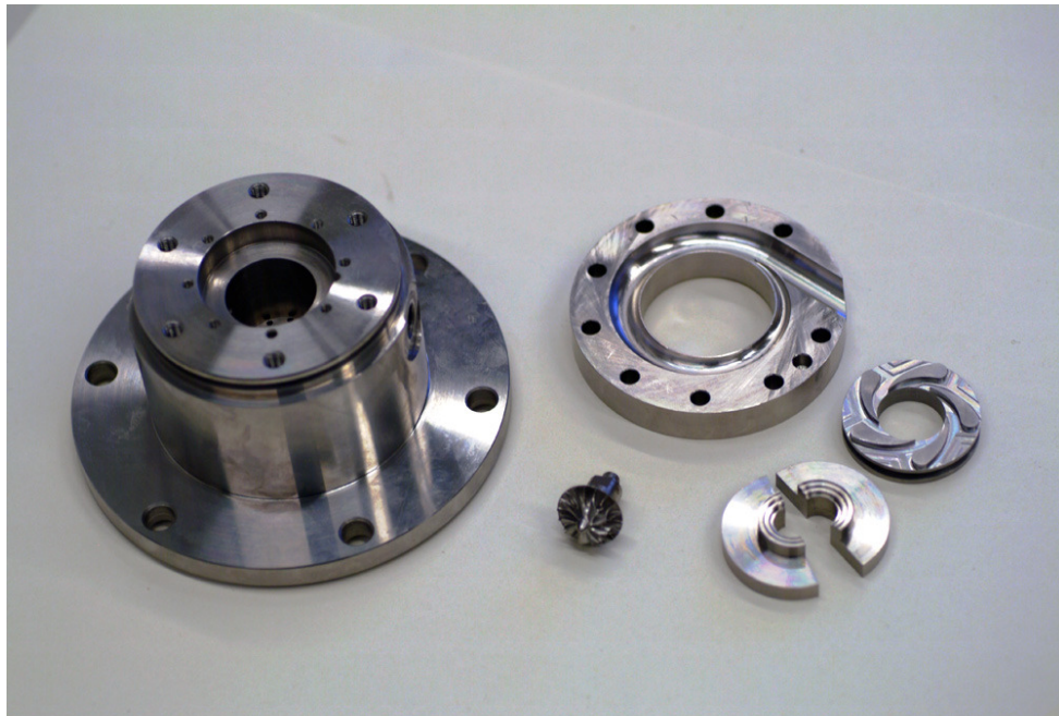
Fig. 6 : pièces usinées du côté turbine de l'unité compresseur-turbine
