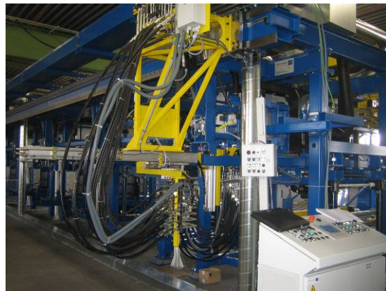
Figur 2: Drei Bilder der Hochdruckschäumenanlage Hennecke KGS-7 inklusive Einspritzmischkopf (unten rechts) in der Kühlgeräteproduktionshalle der Forster Küchen & Kühlgeräte AG in Arbon (CH)
