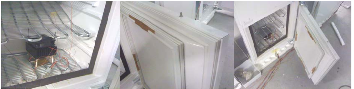
Figur 8: Verbesserung der Türdichtung im Gefrierabteil durch Einsatz einer zweiten, kleineren Dichtung auf der Türinnenseite. Diese dichtet gegen einen eingepassten Stahlrahmen ab.
