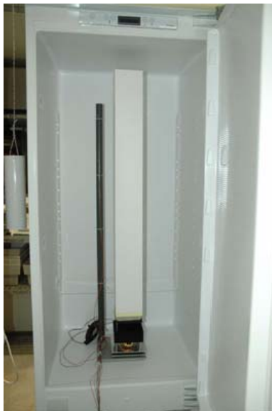
Figur 4: Versuchsanordnung wie sie für die kalorimetrischen Messungen an den verschiedenen geschäumten Geräten verwendet wurde. Diese Konfiguration zeigt von allen untersuchten Aufbauten die homogenste Temperaturverteilung im Schrank.
