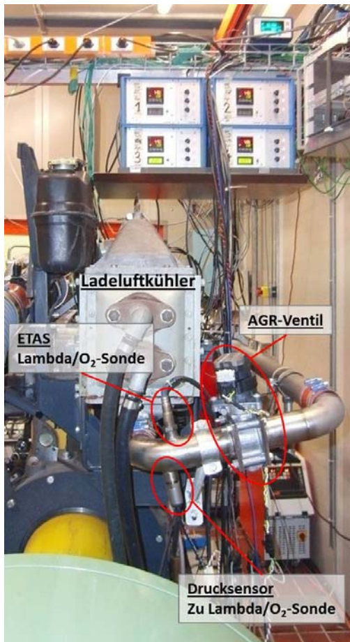
Abbildung 5: Anordnung von Lambda-Sonde und AGR-Ventil
