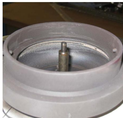
Fig. 24 Links: Brenner mit Standardeinstellungen ohne Anpassung mit T_{\text{Start}} = 330\text{ °C} , T_{\text{Nachheiz}} = 330\text{ °C} . Rechts: Brenner mit T_{\text{Start}} = 380\text{ °C} , T_{\text{Nachheiz}} = 450\text{ °C} und Zackenbecher mit 12 Zacken, tiefer montierte Mischeinrichtung (-8 mm)
