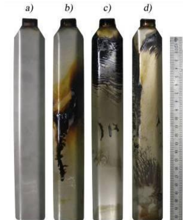
Fig. 32 Verdampferflächen: Stahl gewalzt blank, ohne Vlies Brennstoff Heizöl EL schwefelarm | 20 l/min N_2 | 30 Pa Kaminunterdruck a). 10 kW ( P_{th} ), 700 °C b). 3 kW ( P_{th} ), 700 °C c). 3 kW ( P_{th} ), 900 °C d). 10 kW ( P_{th} ), 900 °C
