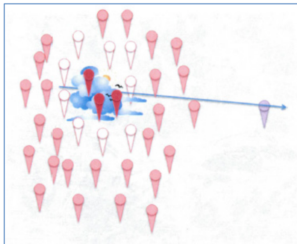
Abbildung 28: Prinzip des Wolkentracking (Quelle: FH NW Wirtschaft)
