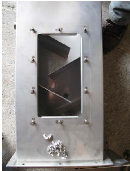
Abb. 12: Der Wäscher Racoonizer der Firma Enerclean besteht aus einem Wasserbecken (Bild links, unten) von welchem das Wasser über den Schlauch nach oben auf eine 4-stufige Treppe (Bild rechts) gepumpt wird.
