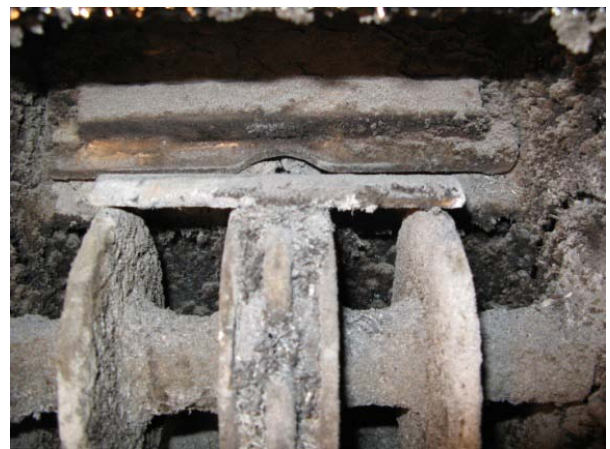
Abb. 4: Das Glutbett der Feuerung wird durch einen Kratzboden bewegt. Rechts ist der Kettenantrieb sowie eine Kratzbodenleiste (Pfeil) sichtbar.
