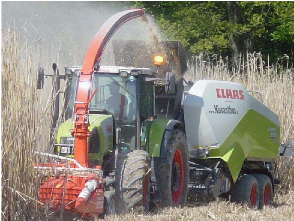
Abb. 2: Die kombinierte Ernte mittels einer Grossballenpresse erleichtert das Handling und die Lagerung. Denkbar wäre auch die Kombination eines Rotationsmähwerkes mit einem Vorbauhäcksler an der Quaderballenpresse. (Quelle: www.miscanthus.lu )
