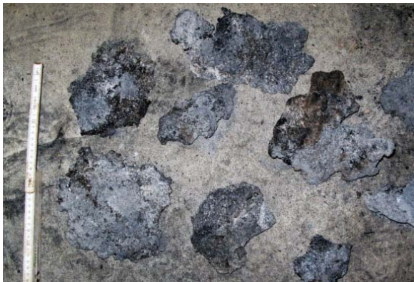
Abb. 5: Die Verbrennung war verbunden mit einer starken Verschlackung des Glutbetts (links). Rechts ist sichtbar, dass am Rande des Glutbetts die Luftzufuhr zu hoch (Flammen) und in der Mitte des Glutbetts keine Verbrennung erfolgte. Die Neueinstellung der Feuerung schaffte Abhilfe.
