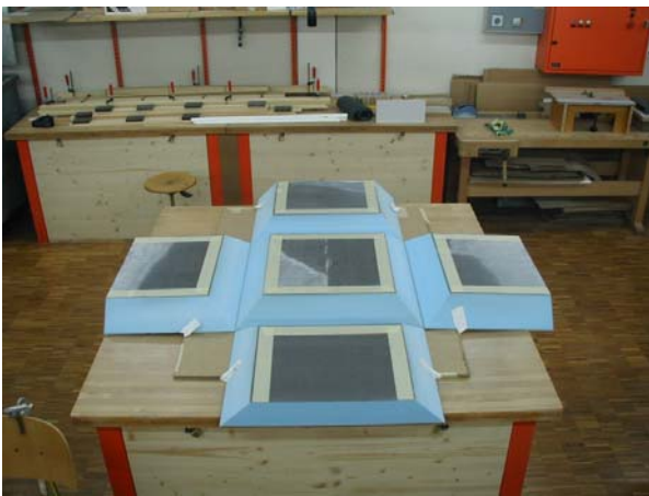
Figure 2 : fabrication du caisson thermique
