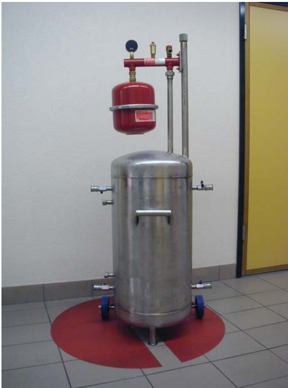
Figure 4 : réservoir tampon fini, avant isolation thermique
