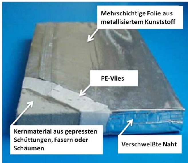
Abbildung 1: Aufbau eines Vakuumisolationspaneels [4]
