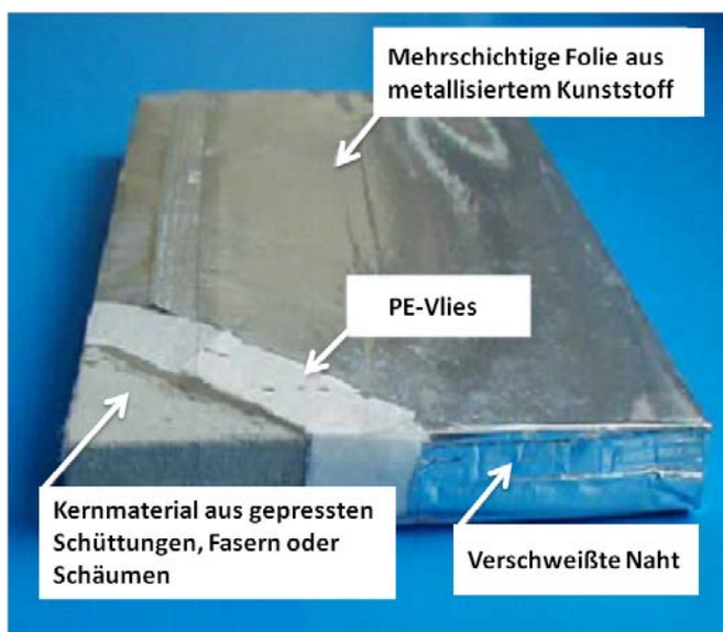
Abbildung 1: Aufbau eines Vakuumisulationspaneels [4]
