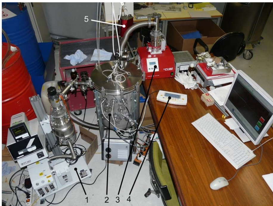
Abbildung 7: Gesamte Messapparatur (1: großer Pumpstand; 2: Rezipient mit Einbauten und Elektrodurchführungen; 3: kleiner Pumpstand; 4: externe Anzeige- und Bedieneinheit der Waage; 5: Massenspektrometer)
