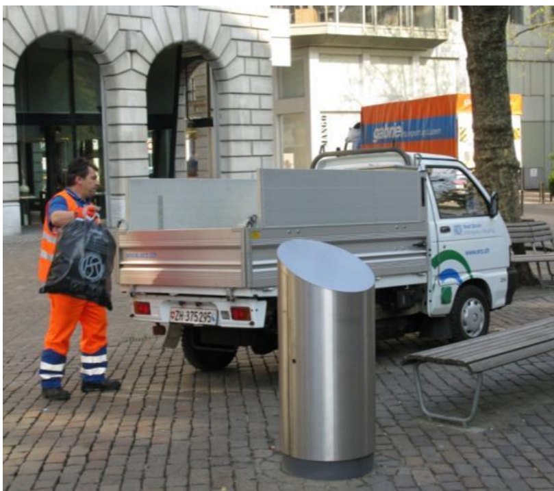
Abb. 22: Typischer Einsatzbereich von leichten Nutzfahrzeugen mit Elektroantrieb im Kommunalbereich (Piaggio Porter, Abteilung Entsorgung und Recycling der Stadt Zürich)
