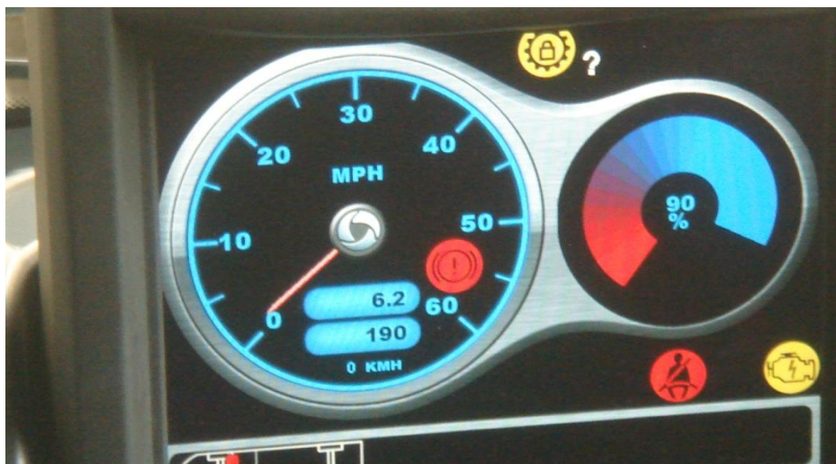
Abb. 12: Auf dem Armaturenbrett wird neben der Geschwindigkeitsanzeige der Ladezustand der Batterie in % angegeben (links)
