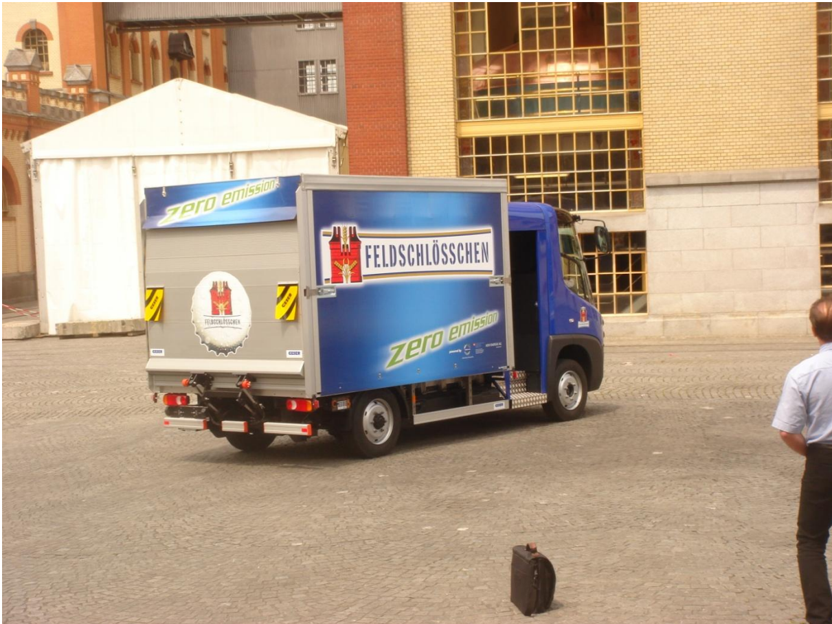
Abb. 2: Fahrzeugaufbau Geser mit Hebebühne
