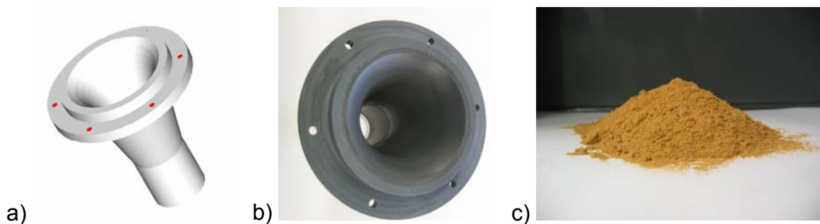
Abbildung 2: a) Zeichnung und b) Foto des trompetenförmigen Ein-/Auslaufbauwerks c) Im Modell als Feinsedimente verwendete gemahlene Baumnussschalen
