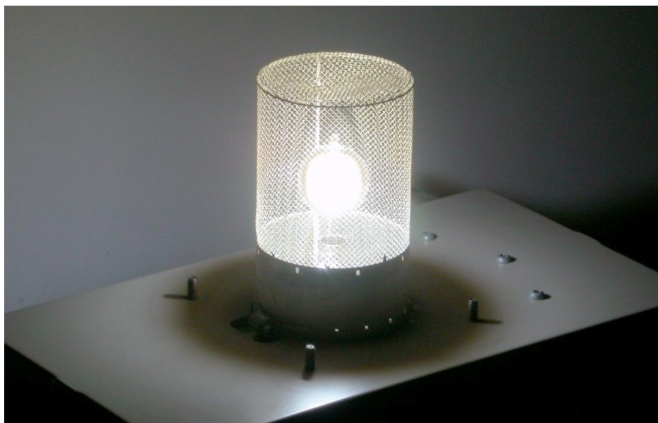
Figure 34 Source lumineuse employée : lampe à plasma de soufre type Solar-1000
