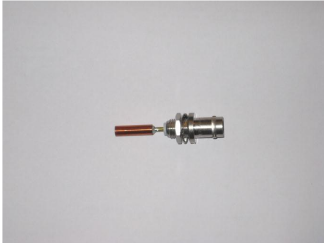
Figure 24 Antenne rectiligne de 5 mm de diamètre et de 8 mm de longueur
