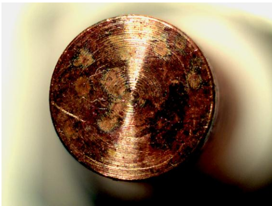
Figure 25 Brulure d'une antenne de 8 mm de longueur et 4 mm de diamètre
