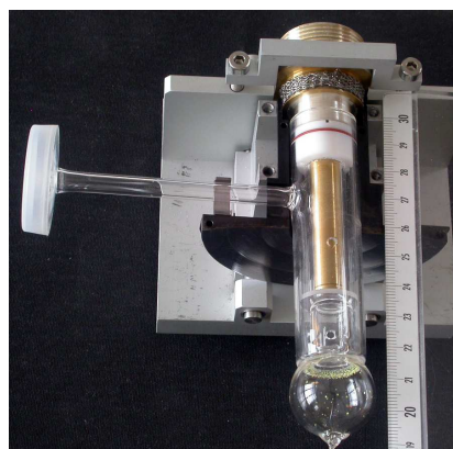
FIG. 2 A. G. : LA TERMINAISON (GRILLE REPARÉE). A. D. : TERMINAISON OUVERTE. LE BOUCHON DE MISE SOUS VIDE DE L'EXTREMITÉ DE L'ANTENNE EST VISIBLE EN BLANC.
