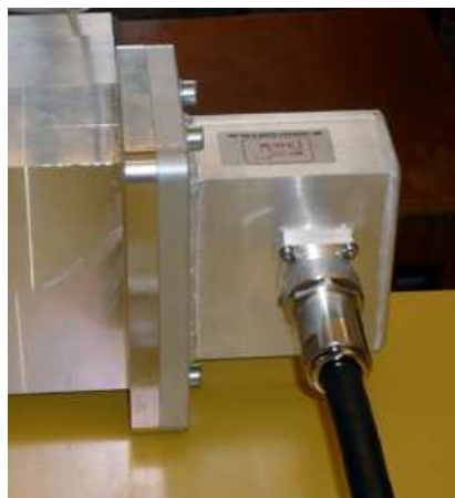
FIG. 1 A. G. : LE GUIDE D'ONDES CREUX (R26) MUNI DES FLUXMETRES ET DES PLONGEURS. A D. : COUPLEUR R26 <-> COAXIAL 7-16"
