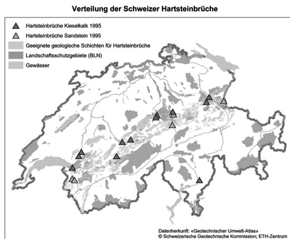
Figur 1. Darstellung potentieller Hartgesteine und nationaler Schutzgebiete sowie der aktuellen Abbaustandorte von Hartgesteinen (Quelle: Geotechnischer Umwelt-Atlas, Schweizerische Geotechnische Kommission).
