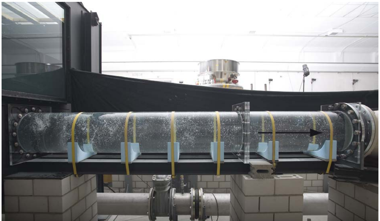
Abb. 3: Zweiphasenströmung (Wasser-Luft-Gemisch) infolge des Einlaufwirbels im Drucksystem.
