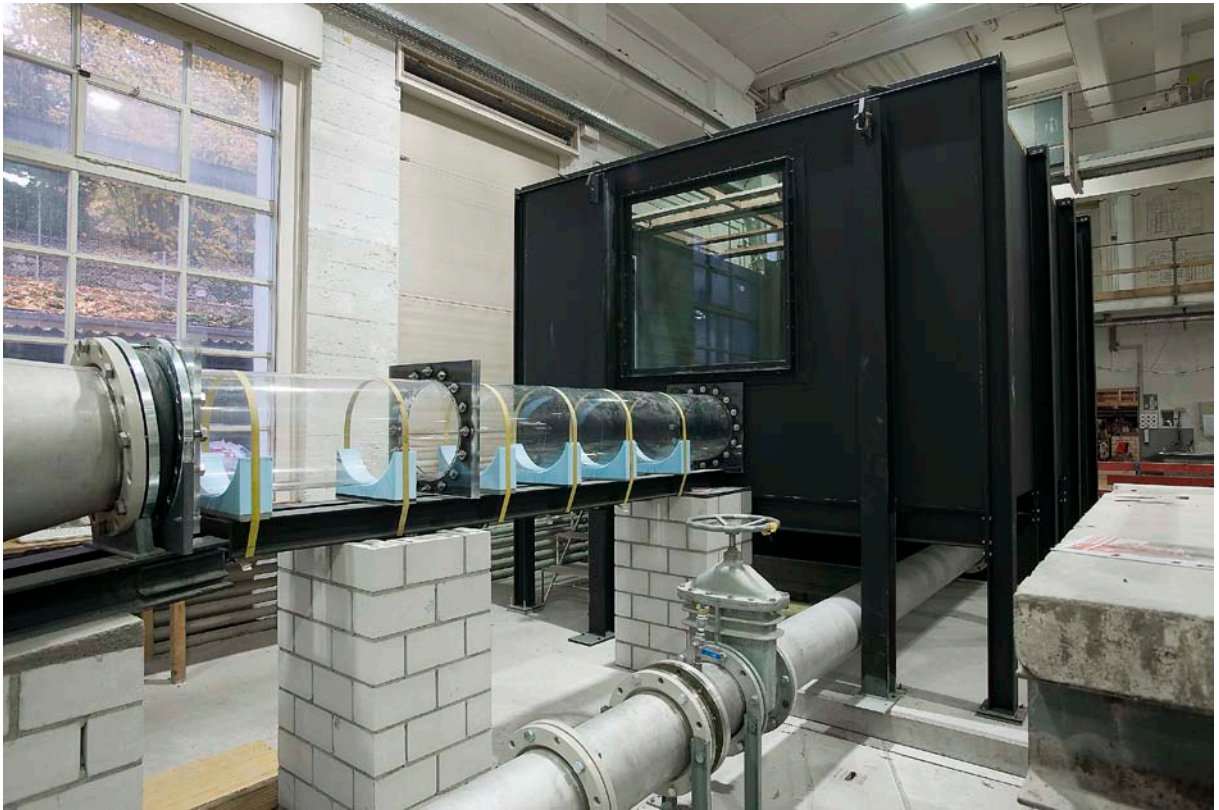
Abb. 1: Physikalisches Modell an der VAW mit schwarzem Tank (Volumen ca. 50 m 3 ) und horizontalem Einlaufrohr aus Plexiglas ( d = 0.4 m).
