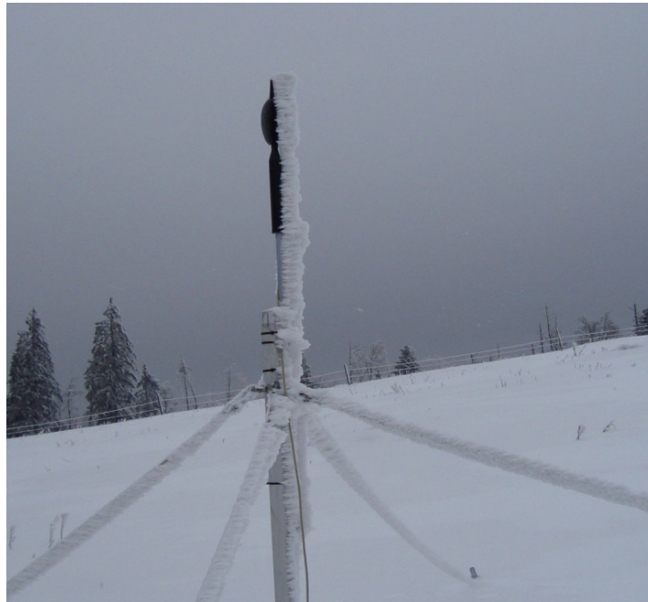
Abb. 49: Eisansatz an der Schallmessung in St. Brais.
