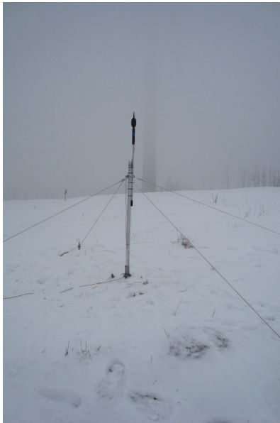
Abb. 45: Links: Installierte Schallmessung mit WEA 1 im Hintergrund. Rechts: Zeitlicher Verlauf des Schallpegels.
