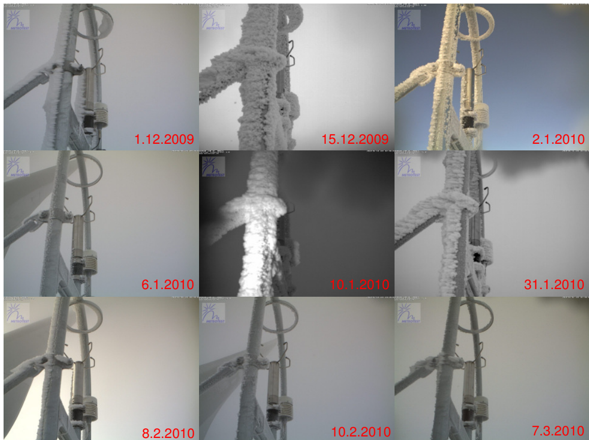
Abb. 19: Maximaler Eisansatz während der einzelnen Vereisungsereignisse im Winter 2009/10.
