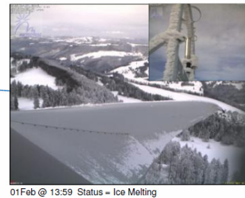
Abb. 40: Abschmelzen des Eises aufgezeichnet durch das Moog/Insensys Rotor Monitoring System am Ende eines Vereisungsereignisses Anfang Februar 2010.
