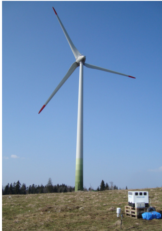
Abb. 42: LIDAR mit WEA 1 im Hintergrund
