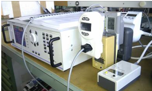
Abbildung 17: Messeinrichtung mit der verwendeten Last (Quanta Ladegerät und Batterie) sowie den, in Serie geschalteten Stromkostenmessgeräten und dem Referenzmessgerät ZES LMG500.
