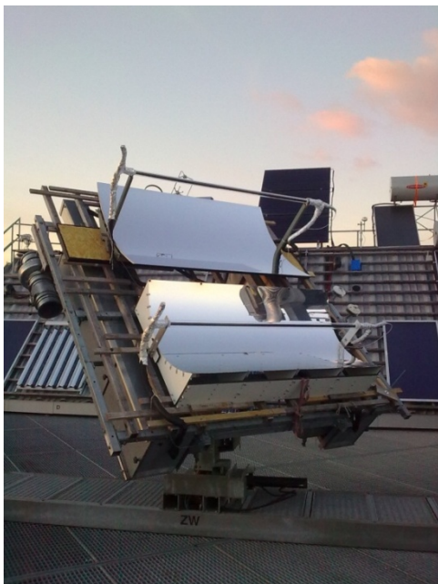
Abb. 1 Konzentrierende Kollektoren auf dem SPF Prüfstand. Messungen mit einem normalen Wasser-Glykol Gemisch bis etwa 120°C.
