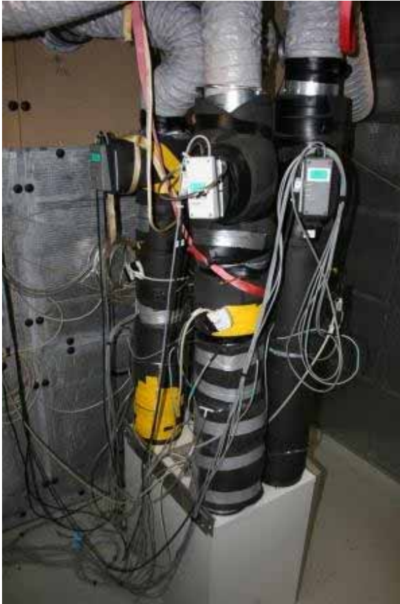
Figur 190: Prüfling mit VOC-Messung.
