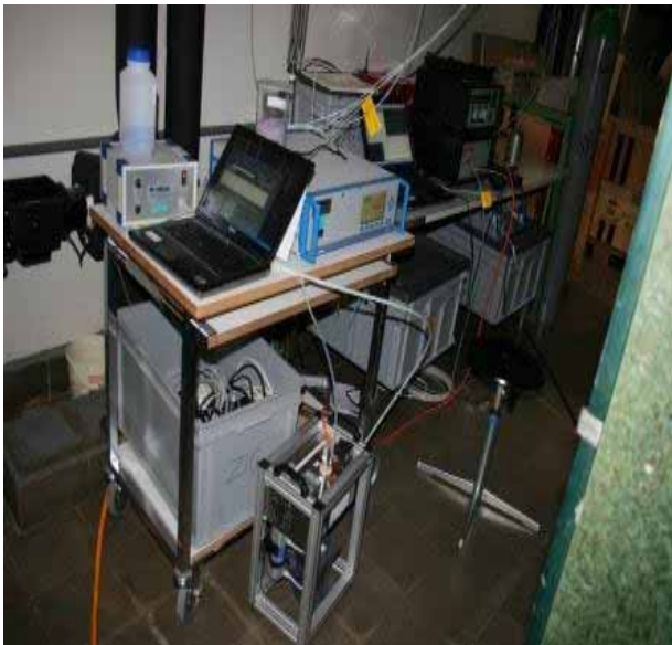
Figur 196: Aufbau Messgeräte für Zuluftkonzentrationsmessung.
