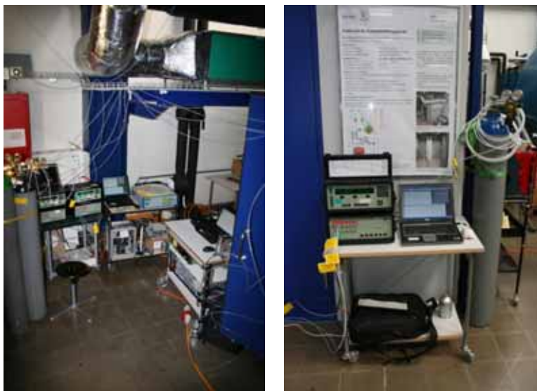
Figur 5: IR-Photoakustik-Gasmonitor Messgeräte mit Mehrpunktsamplern für die Bestimmung von Leckagen bei Kompaktlüftungsgeräten.
