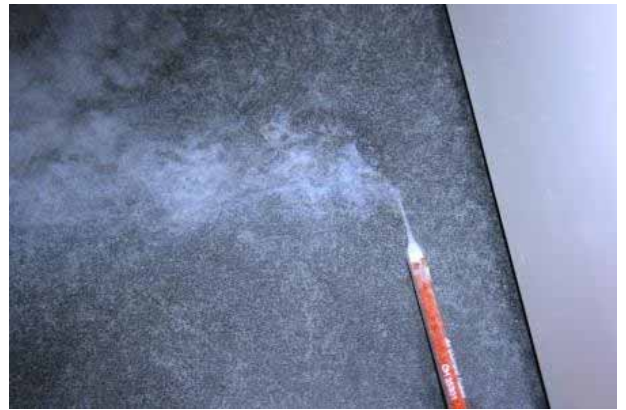
Figur 167: starke Nachströmung in den Aufstellraum.
