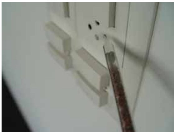
Figur 67: Unterdruck in den Steckdosen.
