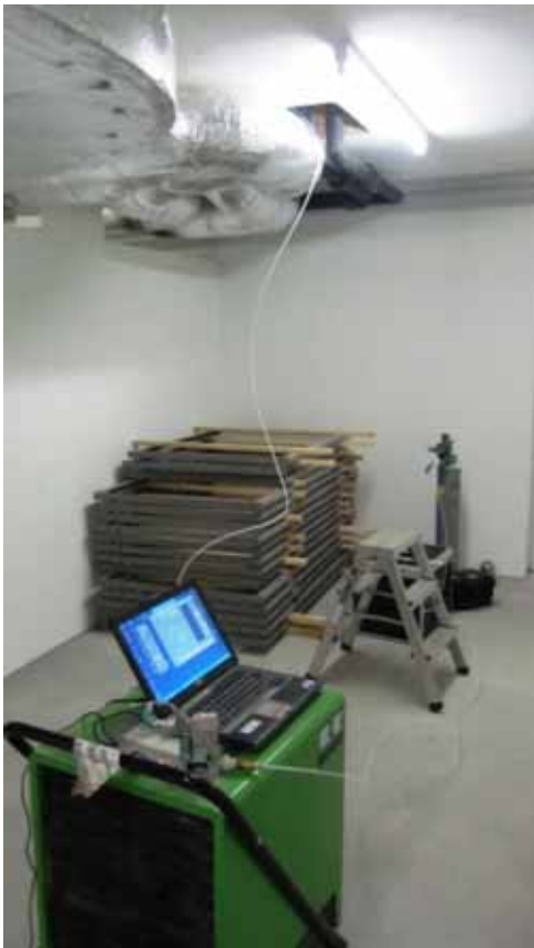
Figur 7: Aufbau für die Dosierung mit Tracergasflasche und Massedurchflussregler.
