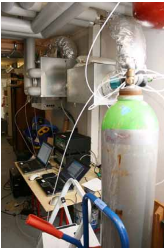
Figur 15: Messaufbau mit Dosierflasche.
