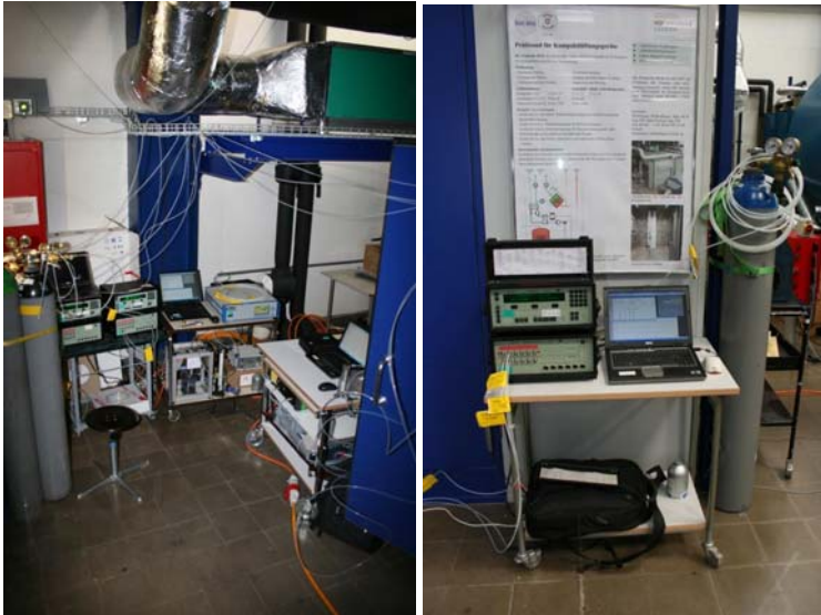
Fig. 3: IR-Spektroskopie Messgeräte mit Mehrpunktsamplern für die Bestimmung von Leckagen bei Kompaktlüftungsgeräten.
