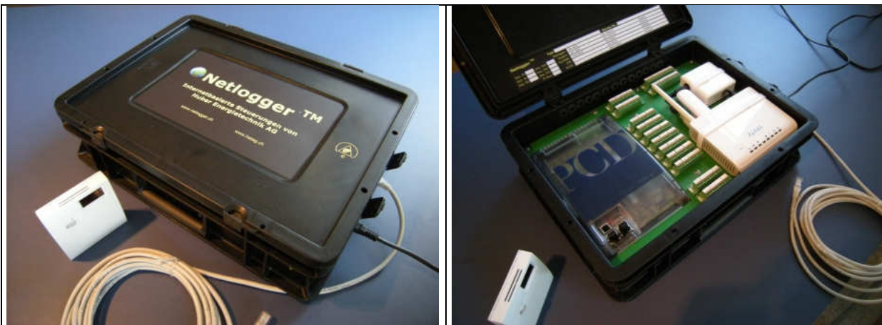
Abb. 4 und 5: Netlogger Home . Sämtliche Komponenten, die klassischerweise in einem Schaltschrank installiert werden müssen, wurden in eine Box integriert.
