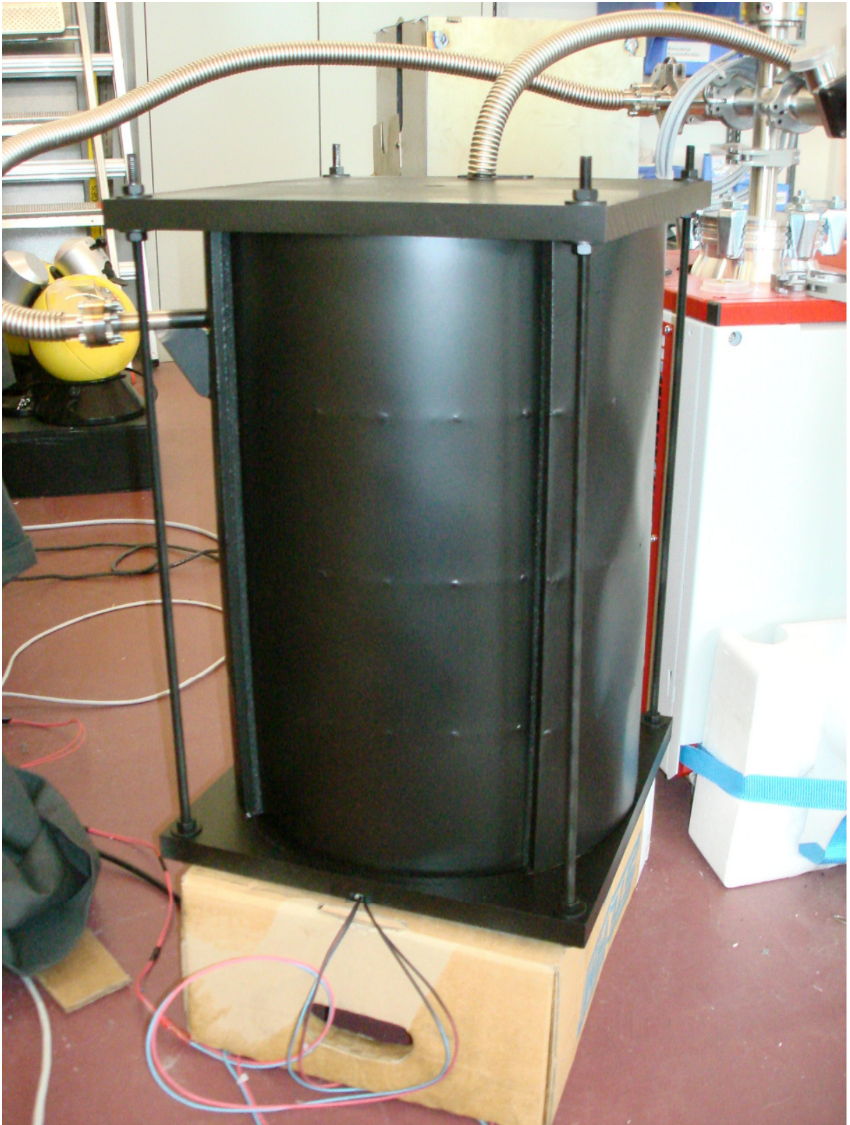
Fig. 19 Funktionsmuster eines mit Vakuum-Spalt isolierten zylindrischen Khlschranks.
