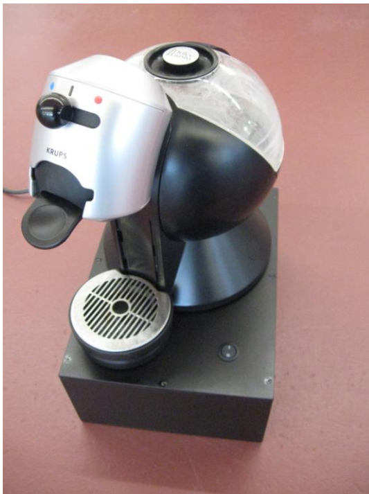
Fig. 1 Funktionsmuster einer Kaffeemaschine mit Vakuumisolation
