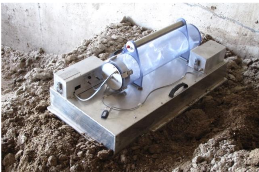
Abbildung 5: Belüftete Probenahmehaube mit Probenehmer und Probenahmebeutel aus Nalophan auf Substrat aufgesetzt.
