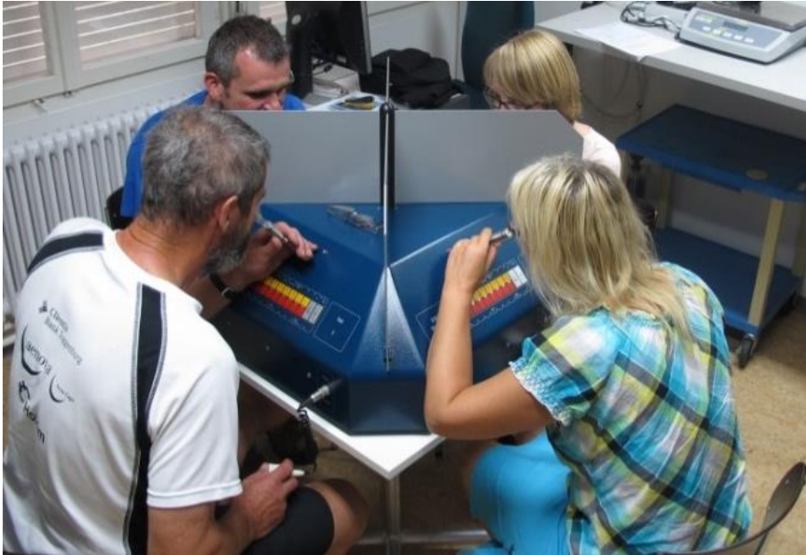
Abbildung 6: Darbietung der Geruchsproben am Olfaktometer TO8 und Bewertung durch vier Testpersonen.
